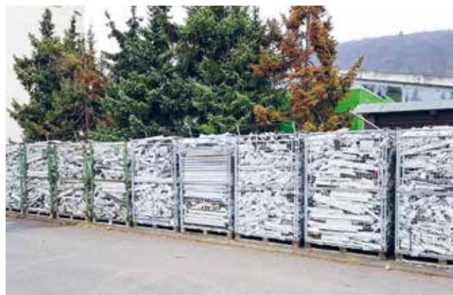
Firmengelände Sammelstelle: PVC Reststücke werden in den Recyclingkreislauf zurück geführt und es können nach deren Einschmelzung neue Fenster daraus entstehen.
