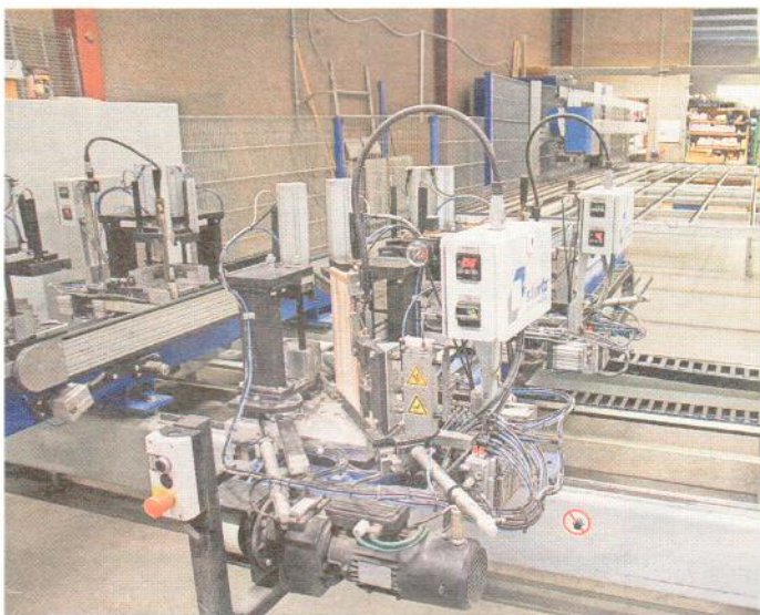
JOMÜ Fenster- und Elementenbau garantiert höchste Verarbeitungsqualität. Im Bild zu sehen eine vollautomatische Vier-Kopf-Schweißmaschine.
